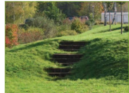
Bild 4.33: Offene Kaskadenrinne zur Ableitung des Regenwassers in eine Mulde zur Retention und Versickerung (PRE-Park, Kaiserslautern, D)
