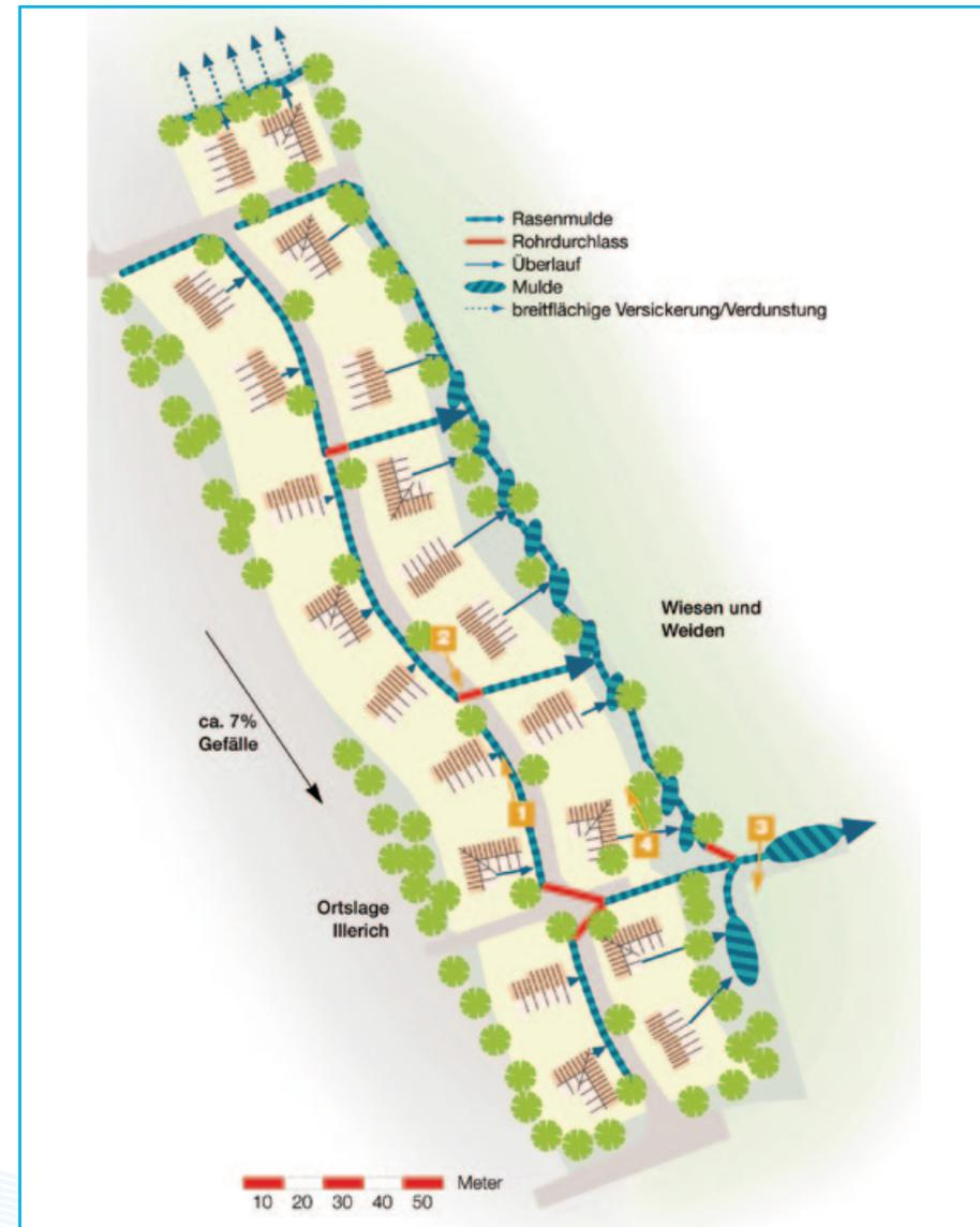
Bild 5.9: Naturnahe Entwässerung einer Hanglage durch Rasenmulden im Neubaugebiet „Im Colm“, Gemeinde Illerich (MUF, 2000)
