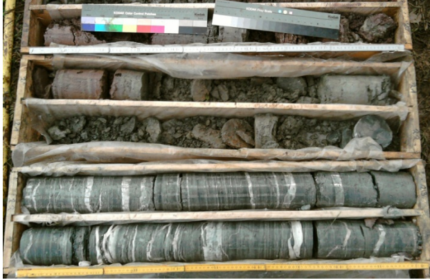
Photo : Carottes de forage issues d'un des 8 forages d'observation réalisés dans la région de Remerschen (« Haff Réimech »).
