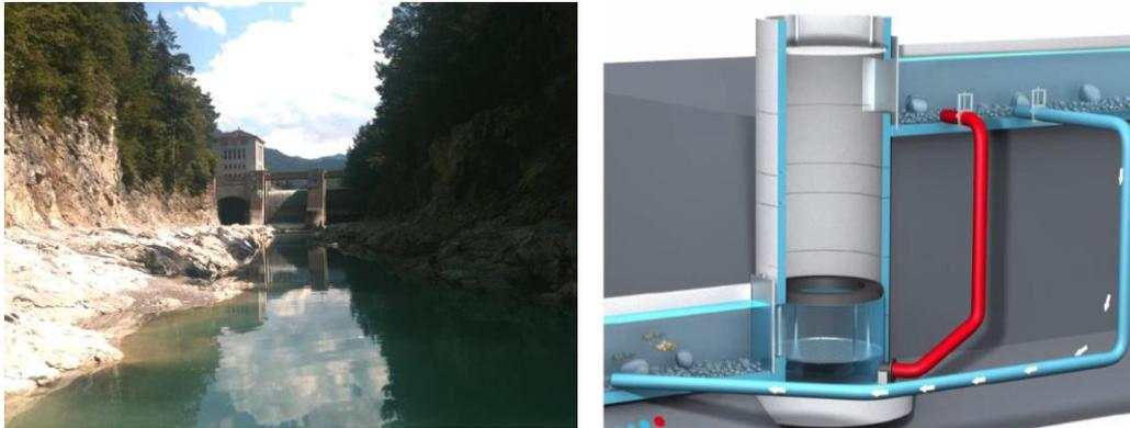
Abbildung 11: Links: Bei Standorten mit sehr beengten Platzverhältnissen sind Sonderlösungen wie Aufstiegschnecken, Fischschleusen oder Fischlifte die einzige Möglichkeit eines Fischaufstieges. Rechts: Schematische Darstellung des Funktionsprinzips einer Fischliftschleuse ([www.der-wasserwirt.at](http://www.der-wasserwirt.at))
