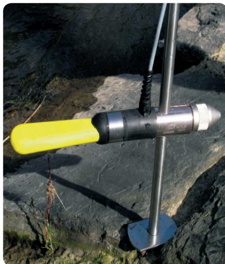
Der induktive Geschwindigkeitsmesser misst die Fließgeschwindigkeit in allen Arten von Wasserräumen, er ist aber besonders geeignet bei geringen Geschwindigkeiten und starkem Pflanzenbewuchs. Wesentliche Vorteile des Messgerätes sind die Abwesenheit bewegter Teile sowie seine Robustheit.
