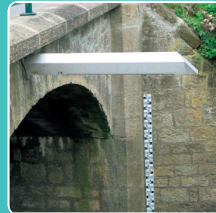
In Richtung Wasseroberfläche ausgestrahlt elektrromagnetische Wellen werden reflektiert und analysiert. Ein Prozessor ermittelt die Distanz zwischen dem Radar und der Wasseroberfläche.
