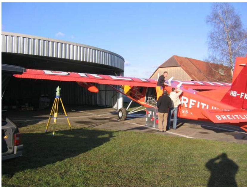
Abbildung 10: Ein Flugzeug vom Typ PC6 wird für die Befliegung vorbereitet, der Laserscanner eingebaut.
