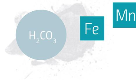
angreifen würden und z. B. zu Korrosion führen können. Hierzu wird das entnommene Rohwasser belüftet und so mit Sauerstoff angereichert. Die Kohlensäure verflüchtigt sich, während das im Wasser gelöste Eisen und Mangan oxidieren und unlösliche Metallflocken bilden. Diese können dann aus dem Rohwasser herausgefiltert werden.
