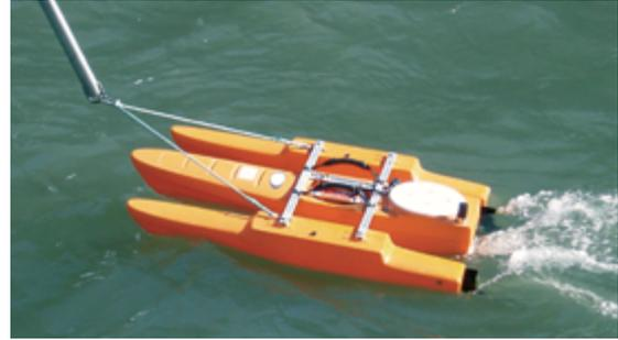
Messung der Fließgeschwindigkeit von Oberflächengewässern mithilfe eines hydrometrischen Flügels (links) und eines an einem Trimaran befestigten Acoustic Doppler Current Profiler (ADCP) (rechts)
