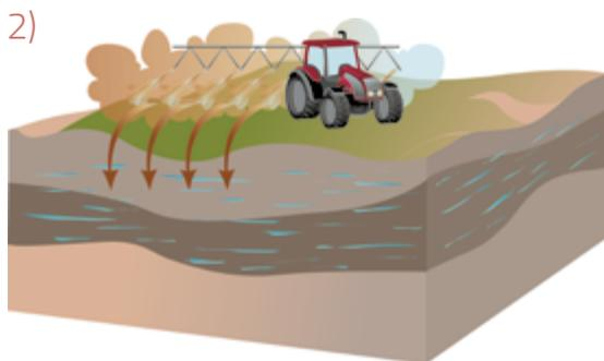
Eine weitere Gefahr für das Grundwasser sind zu hohe Nitratgehalte. Nitrat ( $\text{NO}_3^-$ ) gelangt über verschiedene Wege in den Boden und somit in das Grundwasser:
