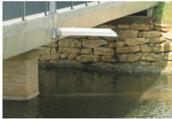
*Wasserstandsradar zur Bestimmung des Wasserstandes*
