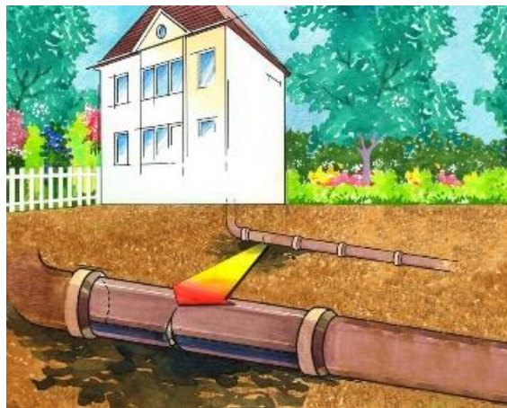
Image n°5 : Schéma avec canalisation, fuite et infiltration dans le sous-sol.
