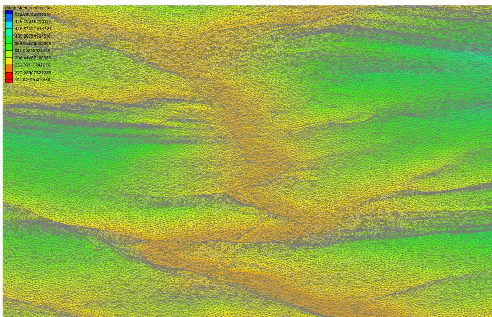
Abbildung 28: Beispiel eines Berechnungsnetzes auf Grundlage des DGM
