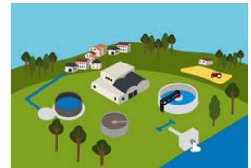
Kläranlage mit vierter Reinigungsstufe zum Schutz des Wassers und generell der Nahrungskette vor Stoffen aus Reinigungsmitteln, kosmetischen Produkten oder aus der Medizin.
