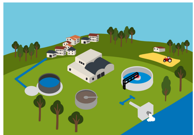
Kläranlage mit vierter Reinigungsstufe zum Schutz des Wassers und generell der Nahrungskette vor Stoffen aus Reinigungsmitteln, kosmetischen Produkten oder aus der Medizin.
