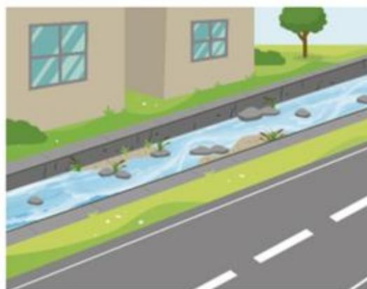
**Après :** Des structures telles que des pierres de perturbation, des bancs longitudinaux ou de la végétation créent des conditions de courant et de substrat variées
