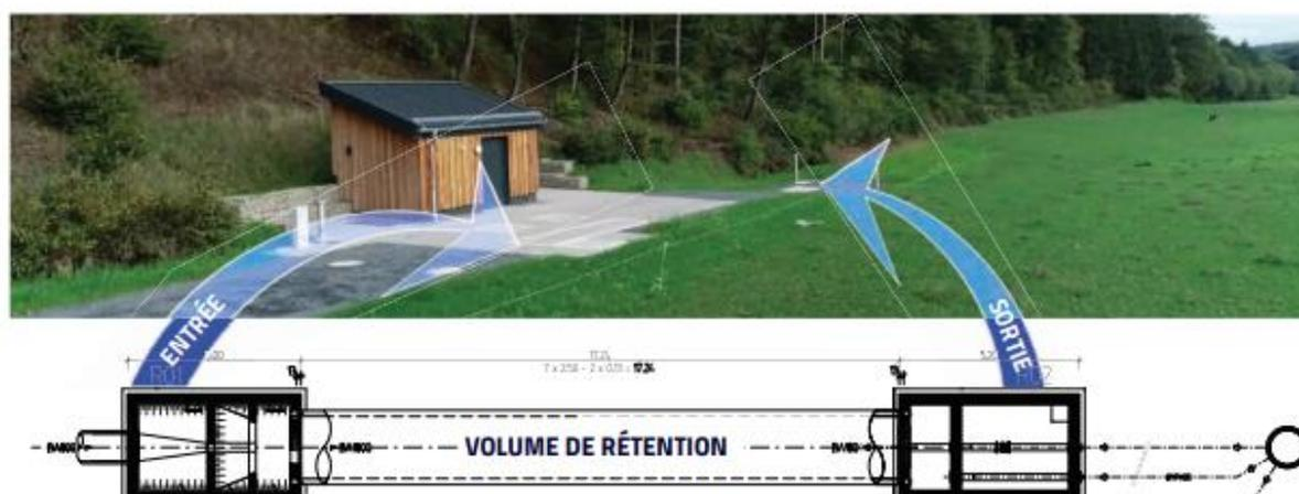
Figure 30 : Bassin de débordement des eaux pluviales à Buschrodt (Photo: SIDEN)
