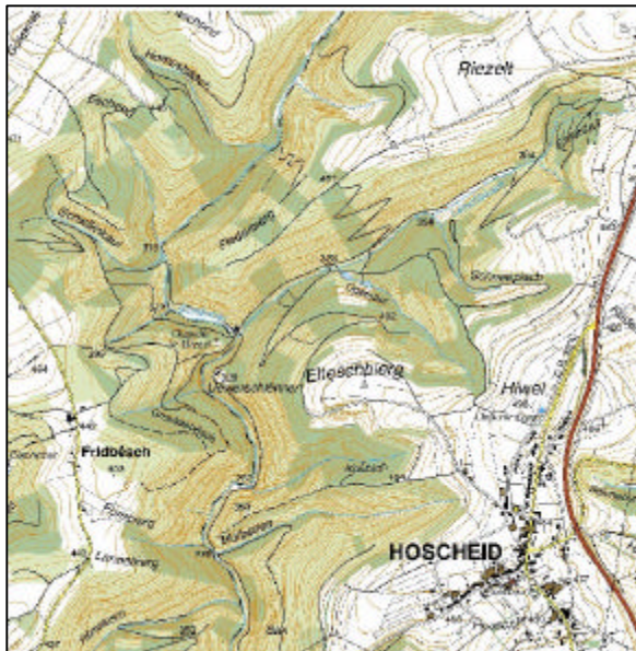
Abbildung 22: Kerbtalgewässer „springen“ allein durch die enge Scharung der Höhenlinien ins Auge. Zusätzlich sind sie durch die fast immer vorhandene Waldbedeckung, die sich gegenüber den landwirtschaftlich genutzten Riedeln deutlich absetzt, direkt in der Karte ausfindig zu machen.
