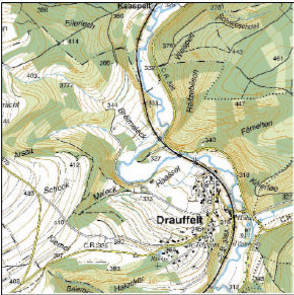
Abbildung 65: Dieser Kartenausschnitt zeigt eine charakteristische Übergangssituation zwischen Mäandertalgewässern und Auetalgewässern. Sie wird durch die unregelmäßige Ausbildung von Laufkrümmungen zwischen den Prallhängen in den Talquerungstrecken dokumentiert. Die bereits schmal ausgebildete Aue ermöglicht diese Linienführung. Die Clerve ist in ihrer Dynamik aber noch im wesentlichen den Mäandertalgewässern zuzurechnen, wenn auch die typischen Talkrümmungsbögen durch punktuelle Anströmungen der Hänge ersetzt werden.
