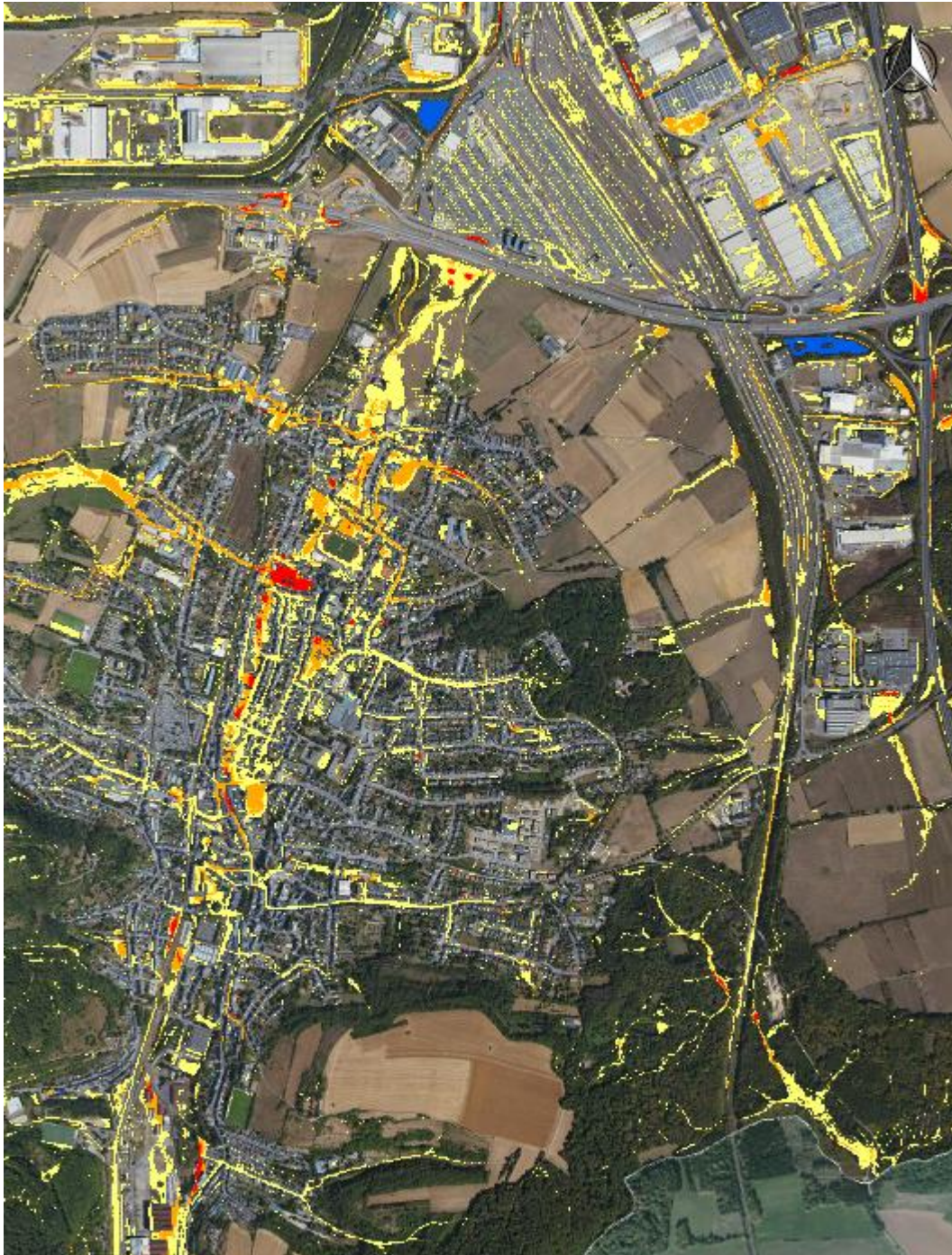
Abbildung 6: Auszug der Starkregenkarte für Düdelingen und das Stellwerk Bettembourg. Berechnungszeit: 1 Stunde (+ 4 Stunden Nachlaufzeit). Wiederkehrintervall: 100-Jährlich
