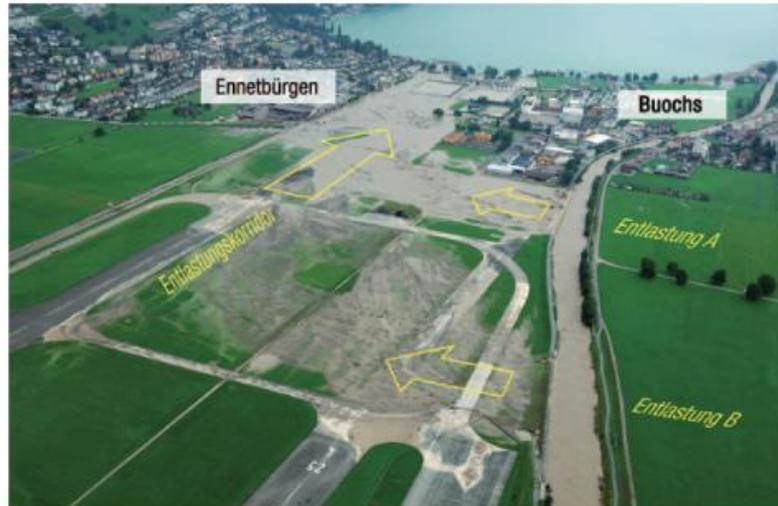
Abbildung 22: Entlastungskorridor der Engelberger Aa, 2005. Quelle: (Grambow, 2013)
