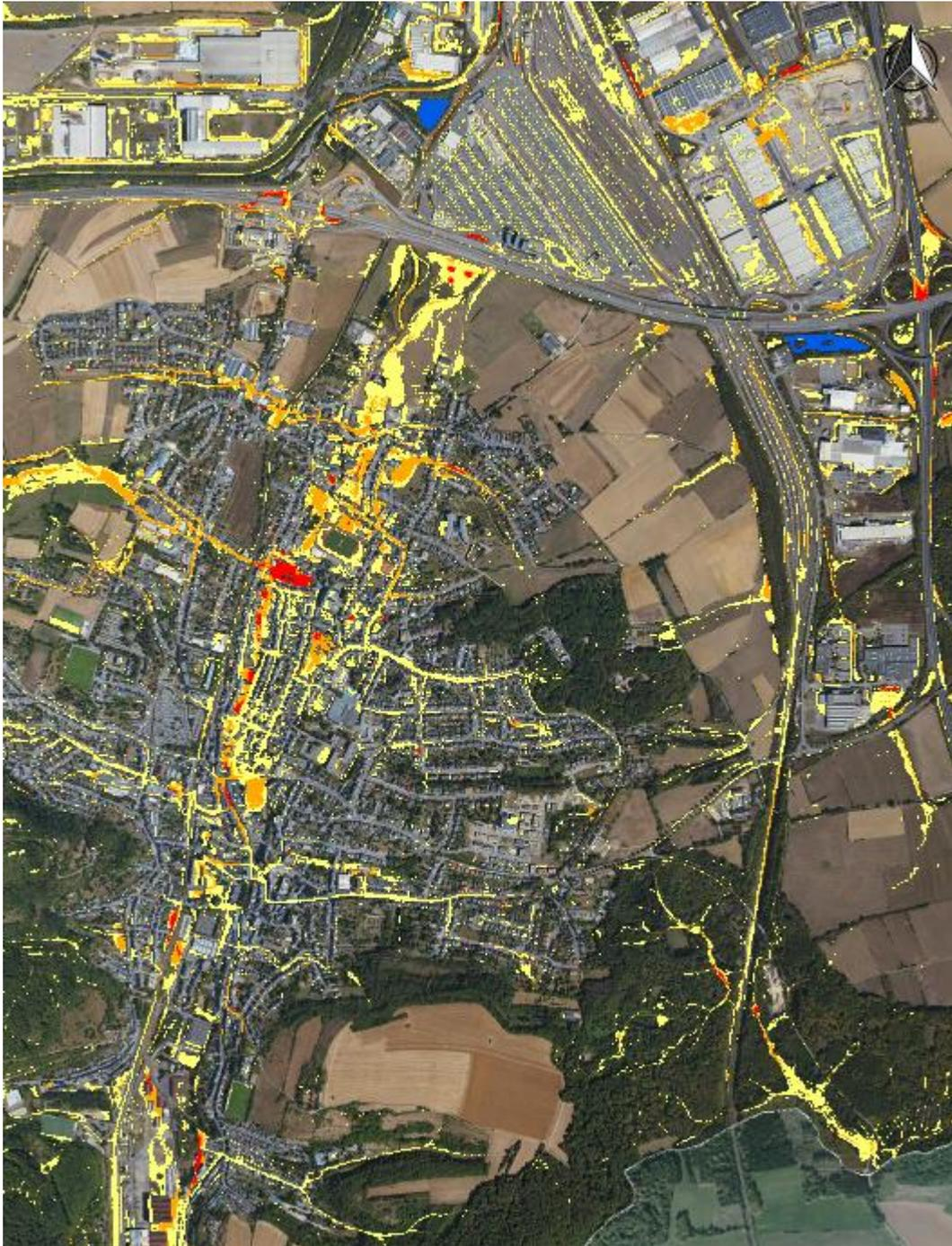
Abbildung 6: Auszug der Starkregenkarte für Düdelingen und das Stellwerk Bettembourg. Berechnungszeit: 1 Stunde (+ 4 Stunden Nachlaufzeit). Wiederkehrintervall: 100-Jährlich
