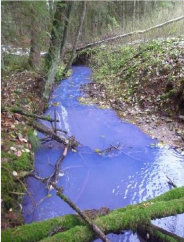
*Photo d'un essai de traçage pour identifier une zone d'infiltration préférentielle et rapide des eaux de surface jusqu'à une source*
