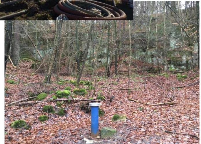
*Photo d'un piézomètre réalisé dans le cadre d'études de délimitation des zones de protection*
